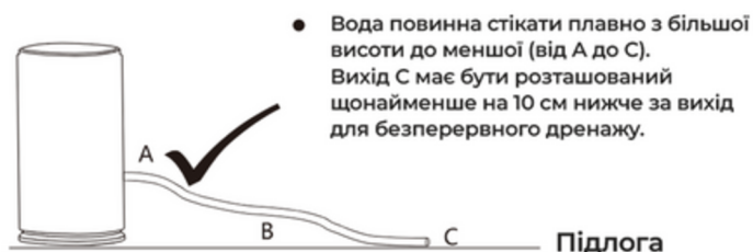
Рисунок 3: Приклад правильного підключення
