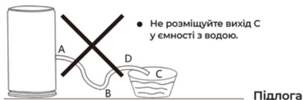
Рисунок 2: Приклад неправильного підключення
